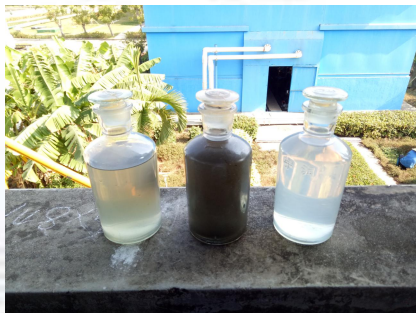
中海沥青（广东）有限公司平板陶瓷膜处理污水前后对比
