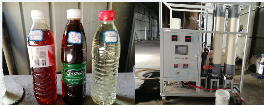
海泉风雷新能源发电股份有限公司木醋液膜蒸馏中试
