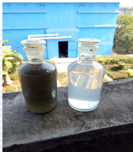
中海沥青（广东）有限公司平板陶瓷膜处理污水前后对比
